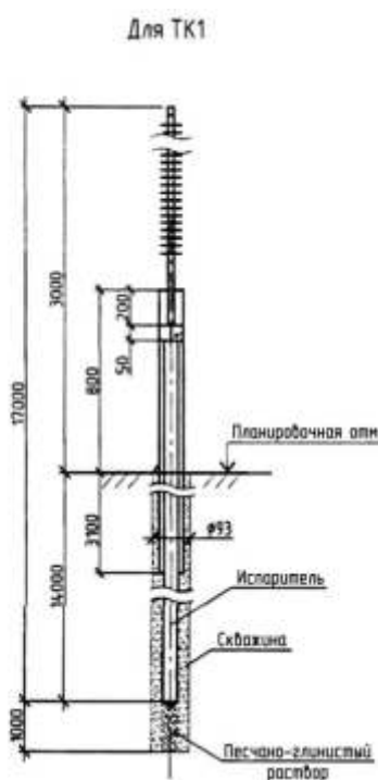
Рис. 4 Схема расположения термостабилизаторов у мачты осветительной с молниеотводом
